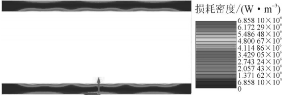
图7 夹件表面损耗密度分布
