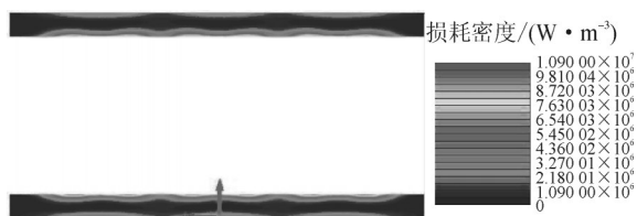
图9 夹件表面损耗密度分布
